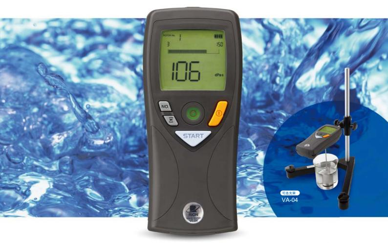
VT-06被设计用于工业制造生产过程中对质量要求控制的场合,可使用在石化、油漆、胶合剂以及食品等行业,并日益被更多的行业采用,例如测量在建筑机械上使用的柴油。 测量通过一个简单的浸没在液体中转动的转子,在液体中转动时由于液体的粘度而使转子产生扭矩,测量转子的扭矩就可直接读出所测流体的粘度值。
